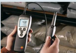
Die Anzeige der Oberflächen-Feuchteverteilung kann optional mittels manueller Eingabe der beiden Parameter Temperatur und relative Feuchte erfolgen. Diese Messwerte können mit Hilfe eines Feuchtemessgerätes ermittelt werden. Besonders gut eignet sich dafür das **testo 625**.
