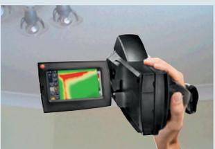
Mit der Wärmebildkamera **testo 890-2** kann die Feuchtemessung optional mit einem externen Funkfeuchtefühler durchgeführt werden. Die Messwerte werden automatisch in Echtzeit an die Kamera übertragen. Eine manuelle Eingabe entfällt. Zusätzlich werden die aktuellen Messwerte mit dem Bild abgespeichert.
