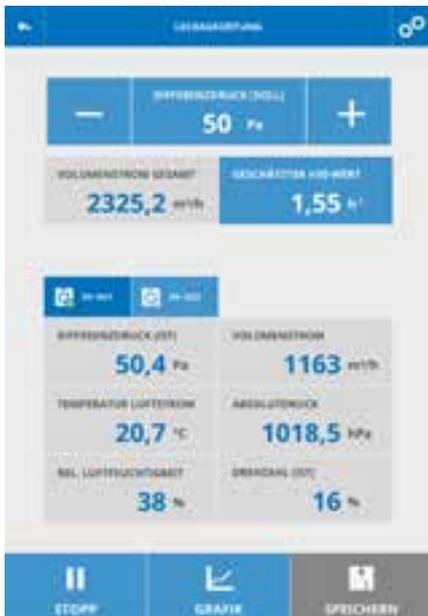
Alle Messwerte werden übersichtlich dargestellt. Zusätzliche Messungen der Lufttemperatur und Luftfeuchte sind nicht notwendig.
