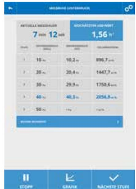
Die Wöhler BC 600 führt die komplette Messreihe gemäß DIN EN ISO 9972 und DIN EN 13829 vollautomatisch durch.
