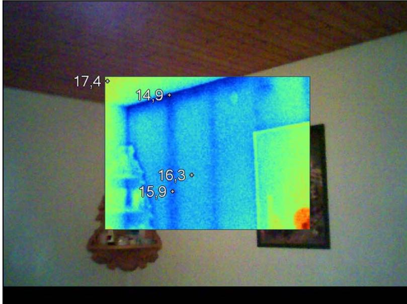
Das Holzständerwerk der Aussenwand ist gut erkennbar - schwere Lasten können leicht befestigt werden.
