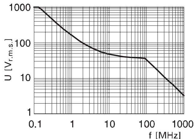
Bemessungsspannung / Rated voltage / Tension assignée
