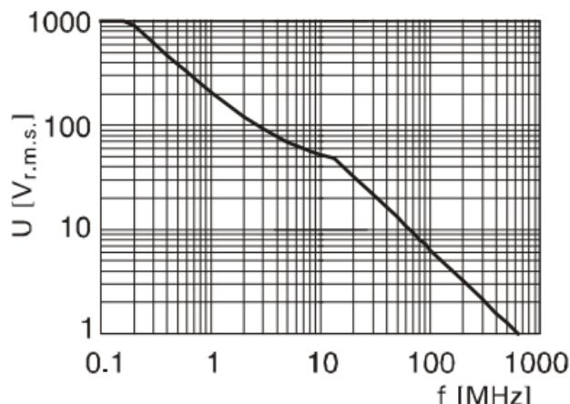
Bemessungsspannung / Rated voltage / Tension assignée
