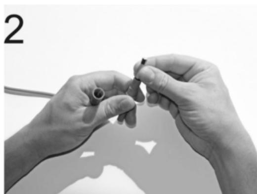
**Vorhandene Sicherung entnehmen und geprüfte Sicherung einsetzen.**
