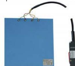
Messbereiche: Plattenmittentemperatur, Wärmefluss
