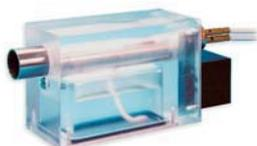
Messbereiche: Trockentemperatur, Feuchttemperatur, Relative Feuchte, Luftdruck, Taupunkt, Absolute Feuchte, Mischung, Enthalpie, Dampfdruck
