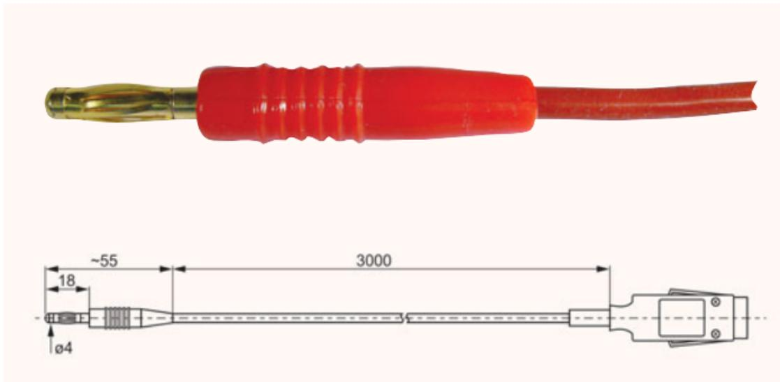
Messelement PT100 4-Leiter Klasse B eingebaut im Steckbereich eines 4 mm Laborsteckers aus Messing (vergoldet).
