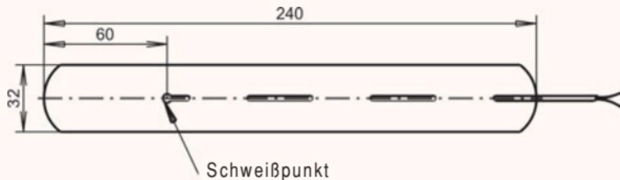
für Oberflächenmessung an Rohrleitungen
