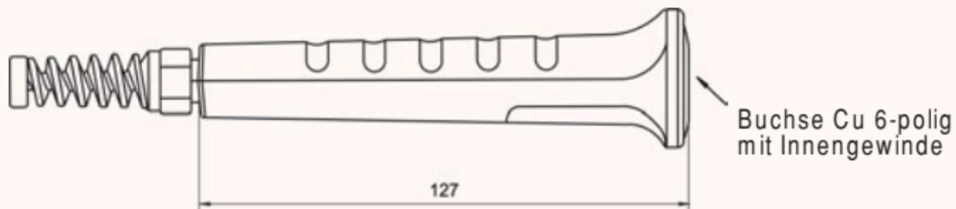
Einbaubuchse: für Rundstecker mit Verschraubung
