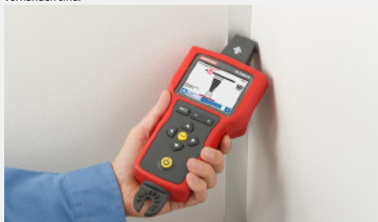
Verwenden der Sensorspitze zum Auffinden von Leitungen in schwer zugänglichen Bereichen.
