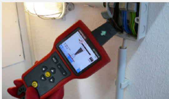
Auffinden spannungsführender oder spannungsfreier Leitungen durch Abnehmen der Verteilerkastenabdeckung.
