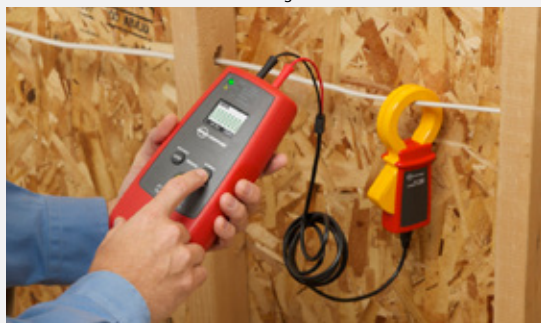
Induzieren des Signals mit der Stromzange, wenn nur isolierte Leiter vorhanden sind.
