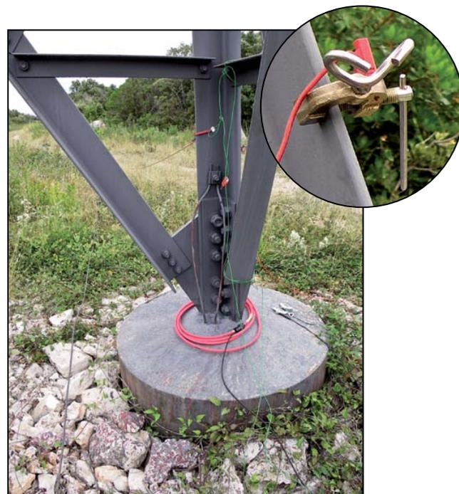
Die AmpFLEX™-Strommessschleifen lassen sich um jeden Mastfuß legen.
