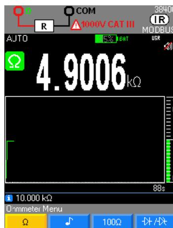
Im Messbereich 50 M $\Omega$  empfiehlt es sich, das Multimeter vom Wall Plug zu nehmen, um eine Beeinflussung durch das Netz auszuschließen und die genannten Spezifikationen zu gewährleisten.
