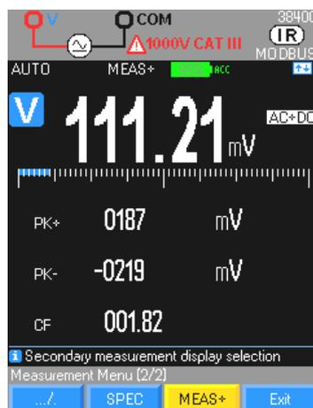
Rasche Peak-Messungen sind in den Sekundärmessungen **MEAS**, **MEAS+**, **PK+** und **PK-** für folgende Messfunktionen verfügbar: V und A (AC, AC+DC); Integrationszeit unter 250  $\mu$ s.
