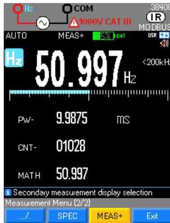
Berechnung der positiven bzw. negativen Impulse gemäß den Triggerbedingungen des Frequenzmessers
