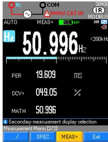
Der Modus Tastverhältnis DCY ist für das Messen aktiver bzw. inaktiver Intervalle von Schalt- bzw. logischen Signalen optimiert. Insbesondere elektronische Kraftstoffeinspritzungssysteme sowie getaktete Netzteile werden mit den variierenden Impulsbreiten kontrolliert, also durch Messung des Tastverhältnisses.
