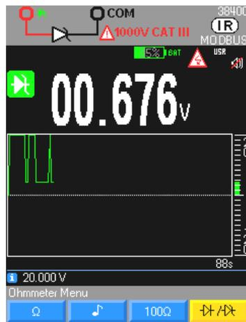
Zener- und LED-Dioden; die Auswahl dieser Diode ist eine identische Funktion wie oben mit maxi. Spannung 26 V und maxi. Strom 10 mA.
