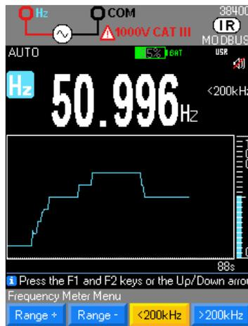
Wählen Sie zum Messen der Frequenz der Spannung die Funktion Hz. Periodenmessung ist als Sekundärmessung möglich. Wenn ein MLI-Filter aktiviert ist, unterliegt die messbare Frequenz der Bandbreitenbeschränkung durch den 300 Hz Filter. Unter 10 Hz bzw. bei ungenügender Signalstärke wird der Wert auf “-----” forciert. Mögliche Bereichswahl mit “Range+ oder -” oder der manuellen Frequenz F <200kHz (standardmäßig) oder F >200kHz
