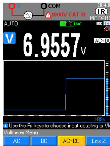
In dieser Position misst man den echten Effektivwert (TRMS) einer Wechselspannung mit ihrer Gleichkomponente (keine kapazitive Kopplung); die so genannte **TRMS**-Messung.
