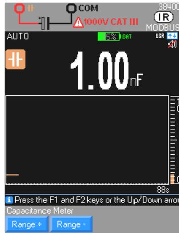
Kapazitätsmessung eines Kondensators in Auflösung 1000 Digits
