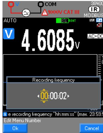
**Freq.** mit der Taste [F3] bestätigen, daraufhin wird das Menü zum Einstellen der gewünschten Speicherhäufigkeit (Stunde-Minute-Sekunde) geöffnet.
