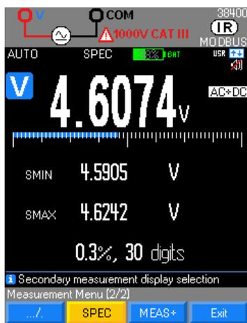
Ausgehend von den technischen Gerätespezifikationen zeigt der Modus **SPEC** die Toleranz der aktuellen Messung direkt an; kein Suchen und Berechnen erforderlich.
