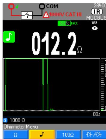
Widerstandsmessen bis 1000Ω mit durchgehendem akustischen Signal bei 4 kHz.
