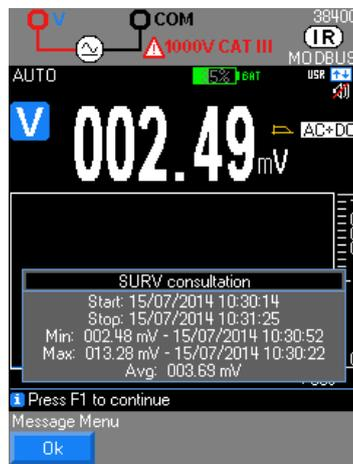
Mit unserer Software SX-DMM besteht die Möglichkeit, eine Bildschirmskopie dieses Fensters abzuspeichern, im Gerät kann dieser Modus jedoch nicht gespeichert werden.
