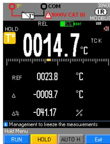
Temperaturmessung mit einem Thermoelement zwischen 2 V-Anschlüssen und COM in °Celsius
