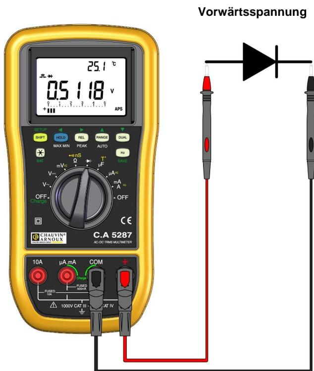
Abb. 47 – Vorwärtsspannung Diodenmessung
