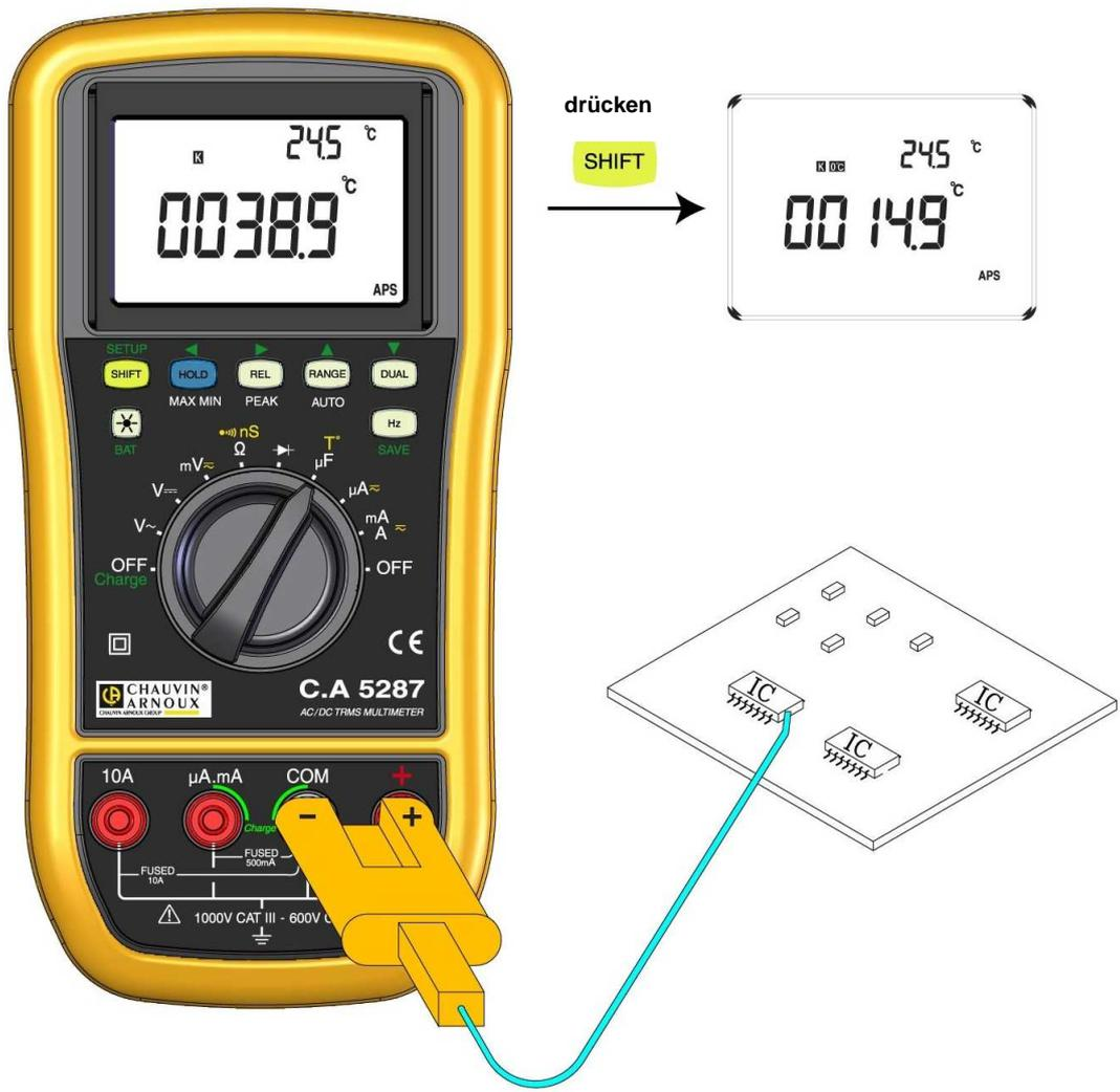
Abb. 50 – Messen der Oberflächentemperatur
