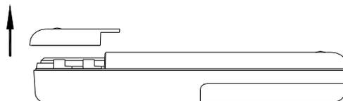
3. Die Batterie mit einer entsprechen Batterie auswechseln.
