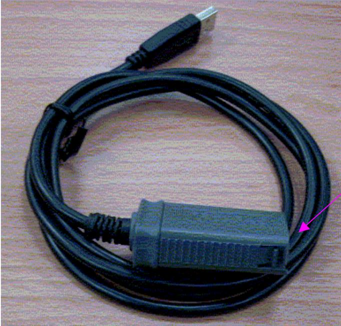
Zum Abnehmen des Kabels vom Multimeter immer den zweiten Schnappverschluss drücken.
