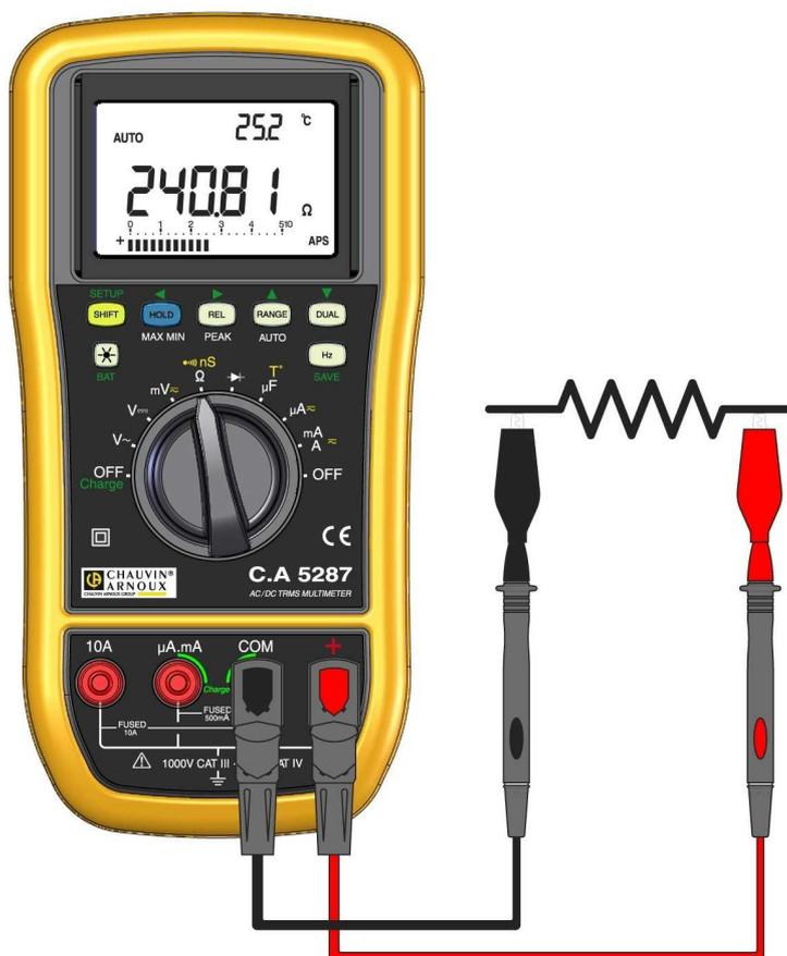
**Abb. 45 – Durchgangsprüfung**
