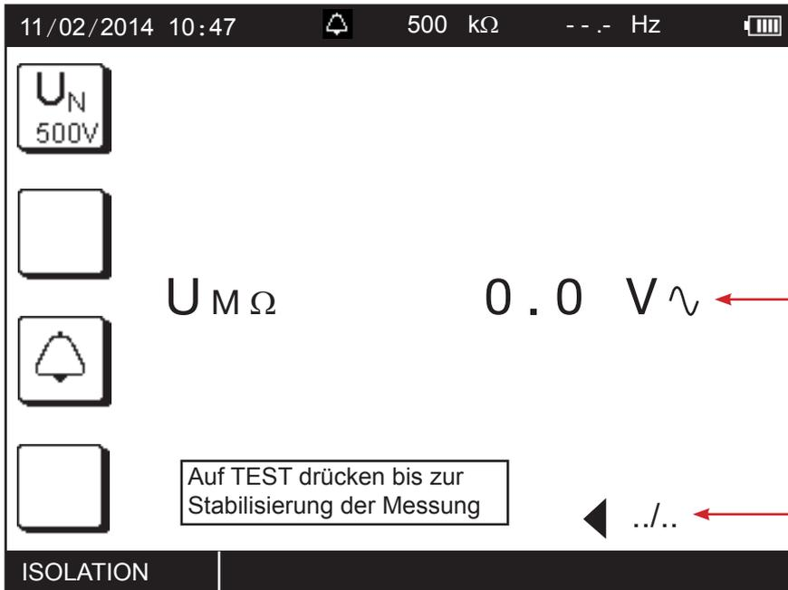
Externe Spannung, die direkt vor dem Start der Messung an den Buchsen vorhanden ist.
