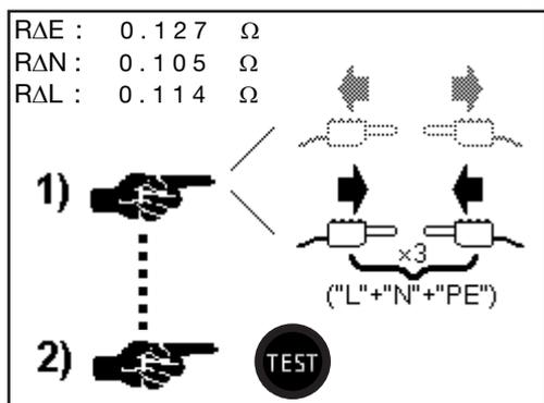
Schließen Sie die drei Messleitungen an die Buchsen L, N und PE an, schließen Sie die Leitungen kurz und drücken Sie die **TEST**-Taste. Der Installationstester misst die drei Messleitungen und zeigt die Werte an. Entweder Sie bestätigen diesen Wert mit **OK** oder behalten den alten Wert mit
