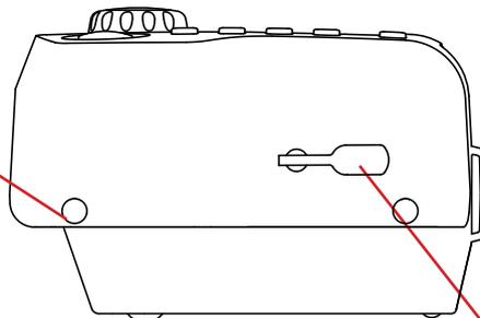
Halterungen für den Tragegurt und Stützen für geeignete Aufstellung des Geräts.
