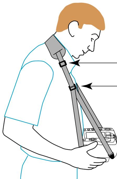
Der Installationstester ist mit einem 4-Punkt-Tragegurt ausgestattet, sodass man die Hände zum Arbeiten frei hat. Befestigen Sie die vier Gurtklemmen an den vier Punkten am Gerät.
