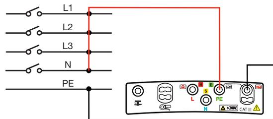
Bei unzureichender Isolation muss jedes der Kabelpaare einzeln gemessen werden, um den Fehler zu lokalisieren.
