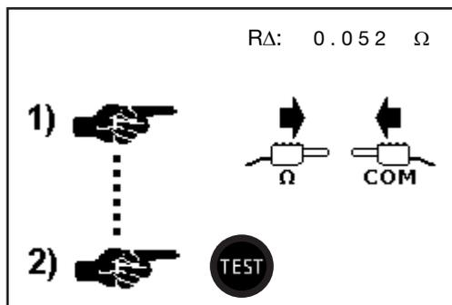
Schließen Sie die beiden Messleitungen an die Buchsen  $\Omega$  und COM an, schließen Sie die Leitungen kurz und drücken Sie die **TEST**-Taste.
