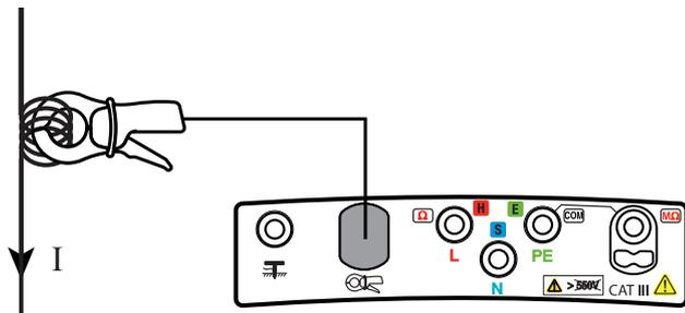
Hier wurde der Leiter 4 mal durch die Zange geführt. Der gemessene Stromwert muss also durch 4 dividiert werden, um I zu erhalten.
