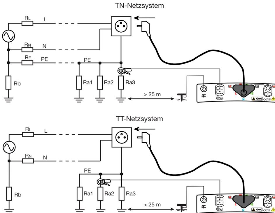
Höhere Genauigkeit erzielt man, wenn die Messung mit dem hohen Prüfstrom erfolgt (TRIP-Modus) – dabei kann aber der FI-Schutzschalter der Anlage auslösen.
