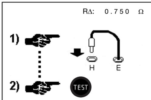
Verbinden Sie mit der Messleitung die Buchse E zwischen den Buchsen H und E mit Erde, und drücken Sie die **TEST**-Taste.
