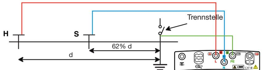
Die Leitungen an die Buchsen H und S anschließen. Nachdem die Anlage spannungsfrei geschaltet wurde, ist die Trennstelle zu prüfenden und die Buchse E an den gewünschten Erdungsanschluss anzuschließen.
