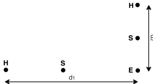
Wenn Sie dieselben Werte erhalten, können Sie der Messung vertrauen. Sind die Werte stark unterschiedlich, kann es sein, dass Erdströme oder eine Wasserader Einfluss auf die Messung nehmen. Ein tieferes Einstechen der Spieße kann ebenfalls nützlich sein.
