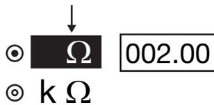
Mit den Tasten ▲▼ die gewünschte Einheit für den Alarm-Schwellwert wählen:  $\Omega$  oder  $k\Omega$ .
