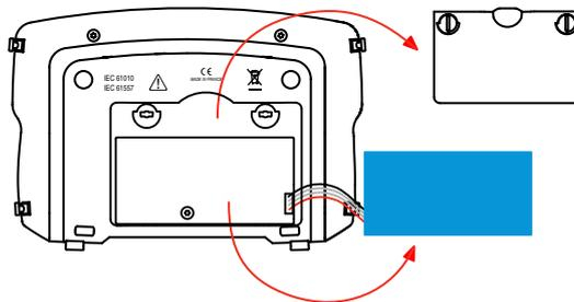
4. Den Akkuanschluss lösen – nicht an den Drähten ziehen!
