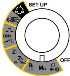
Mit den Messleitungen verbinden Sie das Testobjekt mit den Buchsen COM und MΩ des Geräts. Das Testobjekt darf nicht unter Spannung stehen.
