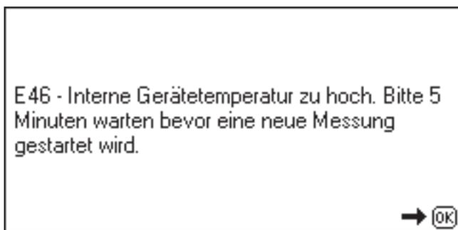
Die Temperatur im Gerät ist zu hoch. Man muss das Gerät abkühlen lassen, bevor die nächste Messung möglich ist. Dies kommt vor allem beim Prüfen von Fehlerstromschutzschaltern vor.
