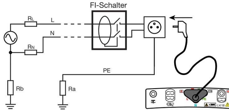
**i** Wenn möglich sollten vorher alle Verbraucher vom Netz, an dem der FI-Schalter geprüft wird, abgetrennt werden. Dadurch werden Störungen durch Fehlerströme, die solche Verbraucher erzeugen, verhindert.
