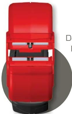
Der Messkopf ist der wichtigste Teil der Erdungsprüfzange, er hat die Produktleistung sicherzustellen. Ausgezeichnete Unterdrückung des Rauschens beim Messen durch einen Aufbau der Chauvin Arnoux® Erdungsprüfzangen mit zwei unabhängigen, geschirmten Magnetkreisen. An den vollkommen glatten Kontaktflächen wiederum haften keine messstörenden Teilchen. Außerdem sorgen die Zentrierteile für optimale Ausrichtung der beiden Messkopfhälften und damit auch langfristig genaue Messungen.
