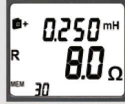
3. Anzeige: Ohmscher- und induktiver Anteil der gemessenen Impedanz
