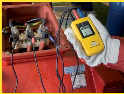
Die beiden Geräte **C.A 6608** und **C.A 6609** sind unverzichtbare Instrumente, um die Phasenfolge der Außenleiter und die Drehrichtung von Antrieben in industriellen Elektroinstallationen anzuzeigen und zu prüfen. Beide Geräte sind voll zugeschnitten auf den Bedarf von Prüf- und Wartungsdiensten in der Industrie, ihre Bedienung ist besonders einfach und die farbliche Kennzeichnung der Messleitungen sowie der Anschlussbuchsen vermeidet die Gefahr von Fehlschlüssen.
