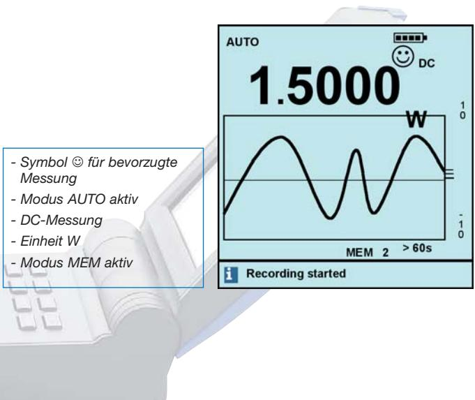
Dank des technologischen Fortschritts, durch den es möglich wurde, sich auf eine "A" Buchse zu beschränken, erfolgt die Strommessung in einer einzigen Position des Schalters fließend über sechs Messbereiche, angefangen von einigen Hundert Mikroampere bis zu zwanzig Ampere. Mit Hilfe von 3 Messleitungen ist es sogar möglich, Strom und Spannung gleichzeitig zu messen und das Ergebnis "V x A" anzuzeigen.
