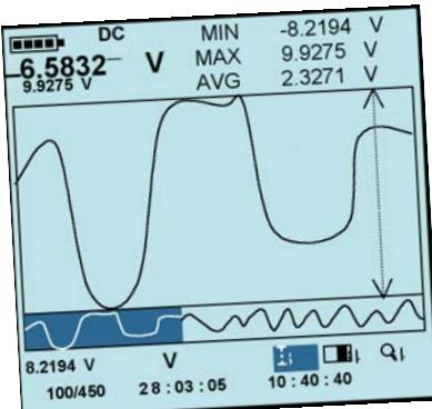
Ferner speichert die Taste **MEM** bis zu 6 500 Messwerte mit Datum- und Uhrzeitangabe in einem Zeittakt, der von 1s bis 24 St. reicht und eine grafische Analyse im Instrument ermöglicht, ganz gleich ob es sich um 1, 2, 3 oder gar 4 gleichzeitige Messungen handelt.
