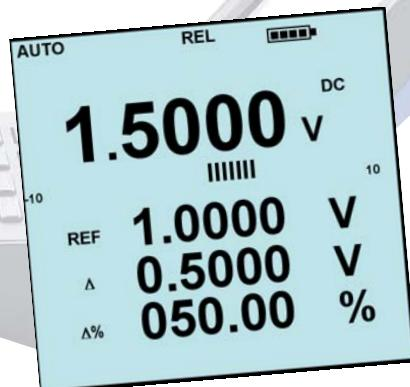
Die Darstellung des Relativmodus **REL** ist sehr komplett, da 4 digitale Anzeigen die Verfolgung des Absolutwertes, der Abweichung in Absolutwert, der Abweichung in % und des Referenzwertes ermöglichen.
