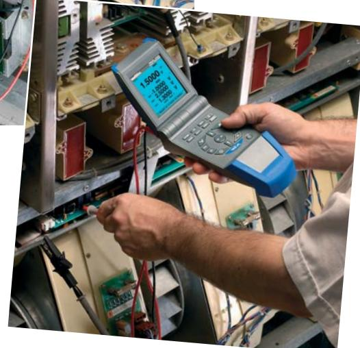
Um die Effizienz und die Sicherheit während der Eingriffe zu verbessern, verfügt das Messgerät nur über 3 Messbuchsen. Bei Anschluss der Messleitung an die "Ampere" Buchse bzw. an die "Volt" Buchse wird die entsprechende Funktion automatisch im AC+DC Modus und im automatischen Messbereich gewählt, so dass sich die nötigen Handgriffe auf ein Mindestmaß reduzieren. Das selbstverlöschende feldtaugliche Gehäuse ist besonders unempfindlich und entspricht der Schutzart IP51.
