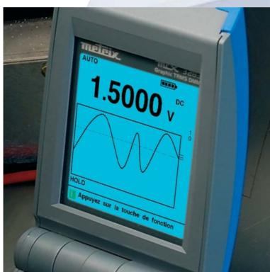
Über die Taste "bevorzugte Messung" ☺ kann eine vom Benutzer vorgegebene, regelmäßig wiederkehrende Messung direkt aufgerufen werden. Diese Taste ermöglicht beim Messen einer beliebigen physikalischen Größe die Umrechnung des Maßstabs und die Festlegung der richtigen Einheit und somit ein direktes Ablesen der ursprünglichen Größe.
