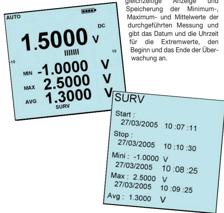
Die Taste **SURV** ermöglicht die gleichzeitige Anzeige und Speicherung der Minimum-, Maximum- und Mittelwerte der durchgeföhrten Messung und gibt das Datum und die Uhrzeit für die Extremwerte, den Beginn und das Ende der Überwachung an.
