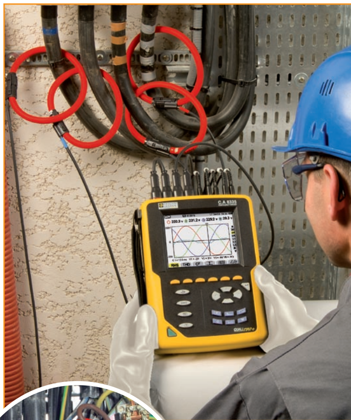
Der BNC-Anschluss der Stromwandler MA200 passt an jedes Oszilloskop.
