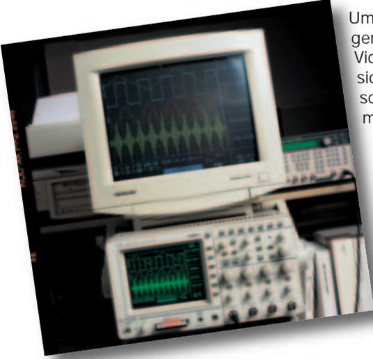
Direkter Anschluss eines VGA-Großbildschirms an das OX 2000
