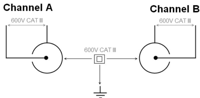
**Die Verwendung von Zubehör mit einer geringeren Spannung oder Messkategorie als 600 V CAT III verringert natürlich den zulässigen Einsatzbereich des Instruments auf diesen niedrigeren Wert für Spannung bzw. Messkategorie.**
