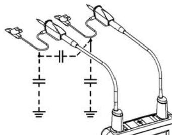
Wegen der unvermeidlichen Störkapazitäten ist es wichtig, die Bezugsmasseklemmen jedes Tastkopfs richtig anzuschließen. Diese Masseleiter sind bevorzugt mit den jeweiligen Massepunkten zu verbinden, um zu verhindern, dass über die Störkapazitäten Rauschsignale eingestreut werden.
