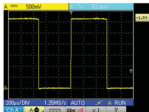
**Nun verstellen Sie die Schraube nach links oder rechts bis das Signal genau rechteckig dargestellt wird, wie auf dem Bild gezeigt. Der Tastkopf ist nun richtig abgeglichen und Sie können den Isolerring wieder verdrehen, um die Einstellschraube zu verdecken.**
