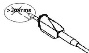
Diese Vorsichtsmaßnahme ist besonders wichtig für Tastköpfe mit zugänglichen BNC-Anschlüssen mit blanker Metallhülse. Die mit dem Instrument gelieferten Zubehöerteile sind dagegen sicher.
