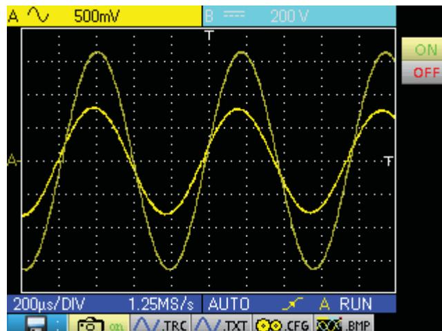
Der Inhalt des Referenzsignalspeichers geht beim Ausschalten des Geräts sowie bei Abschalten des Kanals oder der Referenz-Funktion verloren.
