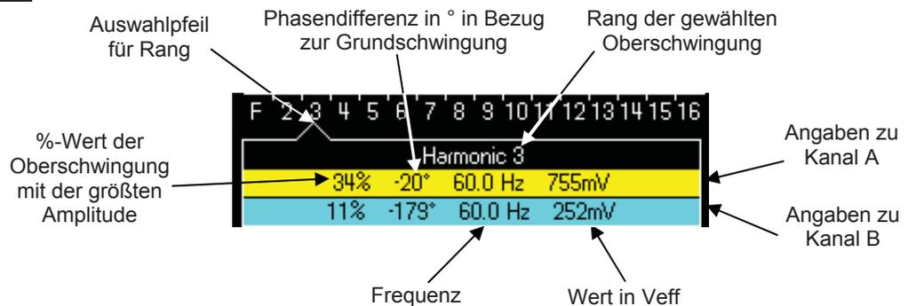
In diesem Fenster erscheinen die Messwerte zum jeweils ausgewählten Oberschwingungsrank in jedem Kanal. Über den Messwerten erscheint der Rang der angewählten Oberschwingung (Harmonic). Die folgenden Messwerte werden in zwei Zeilen mit den jeweiligen Kanalfarben angezeigt:
