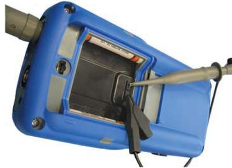
**Schließen Sie den abzugleichenden Tastkopf wie gezeigt an den Abgleich-Ausgang des Oszilloskops und einen Eingangskanal an.**
