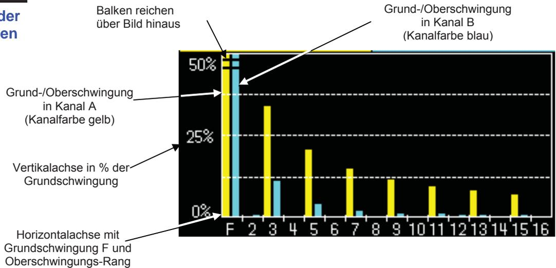
In diesem Grafikfenster werden die Oberschwingungen von Rang 1 (Grundschwingung F) bis 16 als Balkendiagramm angezeigt. Der Benutzer kann die Anzeige auf die Darstellung der nächsten Oberschwingungen der Ränge 17 bis 31 umschalten. Die Höhe der Vertikalanzeige richtet sich nach dem Zoom-Faktor der Achse (hier: 50 %). Dieser lässt sich im Menü »Erfassung« (Acq) einstellen (siehe S. 61).
