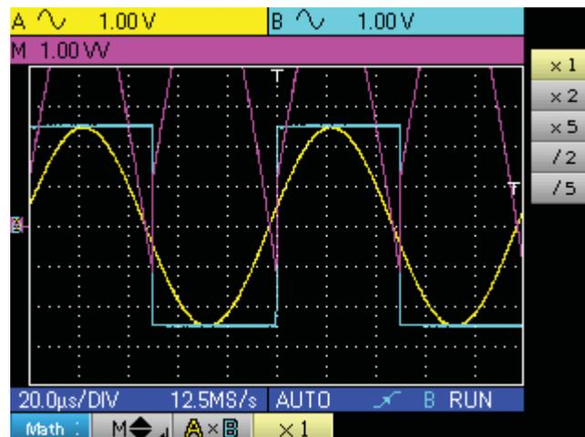
In diesem Beispiel ist die Scheitel-Amplitude des resultierenden Signals  $2,5 \text{ V} * 2,5 \text{ V} = 6,25 \text{ VV}$
