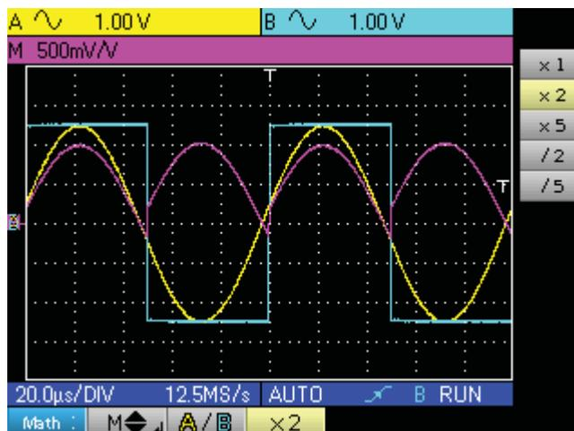
Die Empfindlichkeit in Kanal M beträgt nun 500 mV/V und die positive Scheitelamplitude des resultierenden Signals bemisst sich zu 1 V/V (2 Teilstriche)
