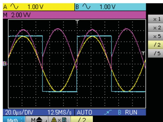
Die Empfindlichkeit in Kanal M ist nun 2 VV/div und die Signalamplitude beträgt:  $3,125 * 2 \text{ VV} = 6,25 \text{ VV}$ .
