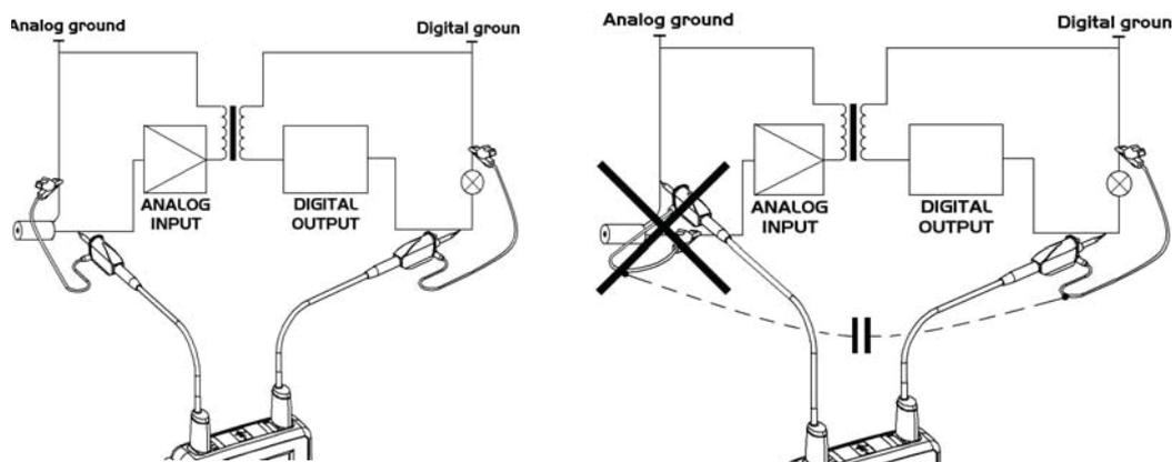
Bei falschem Anschluss (siehe Bild rechts) würde über den digitalen Masseanschluss durch die Störkapazität ein Rauschen in den Eingang des Analogsignals eingespeist.
