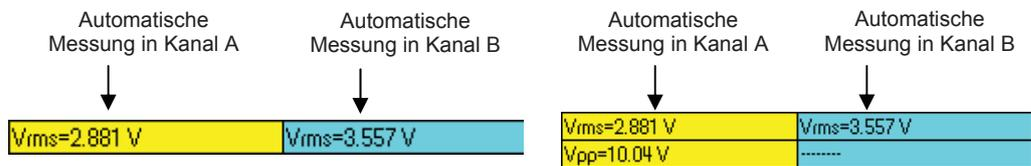
In diesem Bereich werden die ausgewählten automatischen Messungen angezeigt. Pro Kanal können bis zu 2 Messungen ausgewählt und angezeigt werden.
