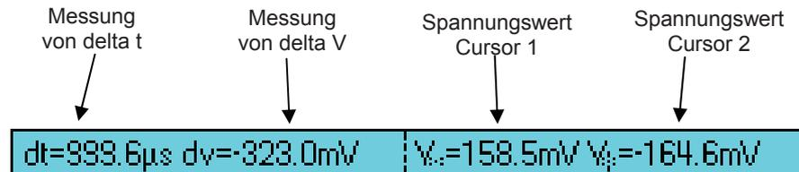
In diesem Bereich werden die Cursor-Messungen angezeigt. Die Hintergrundfarbe entspricht der Farbe des Kanals in dem die Cursorsen aktiv sind. Die Cursor-Messungen betreffen folgende Werte:
