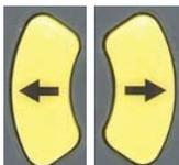
Die Navigation im waagerechten Hauptmenü erfolgt mit den Links- und Rechts-Pfeiltasten.
