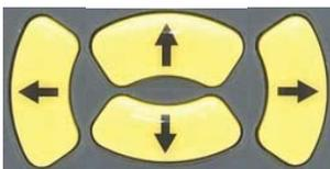
Die Pfeiltasten ermöglichen die Navigation im aktiven, gelb hinterlegten, Bereich des Dialogfensters.
