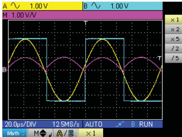
Da hier die positiven Scheitelspannungen der beiden Signale in A und B jeweils gleich sind (2,5 V) ergibt die Division an dieser Stelle den Wert 1 V/V und das resultierende Signal belegt 1 Raster-Teilung. Zur deutlicheren Signal-Darstellung kann man nun einen Koeffizienten x 2 oder x 5 wählen:
