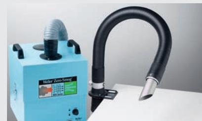
Tragbares Absauggerät für den Einsatz an einem Arbeitsplatz
