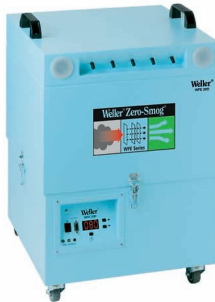
Das WFE 20D ist für die Direktabsaugung am LötKolben konzipiert. Bis zu 5 Weller FE-LötKolben können direkt angeschlossen werden. Indirekt, über das als Zubehör erhältliche Rohrsystem 50, bis zu 40 FE-LötKolben. Die leistungsstarke, wartungsfreie Turbine erzeugt einen Unterdruck von max. 12.000 Pa und ist
