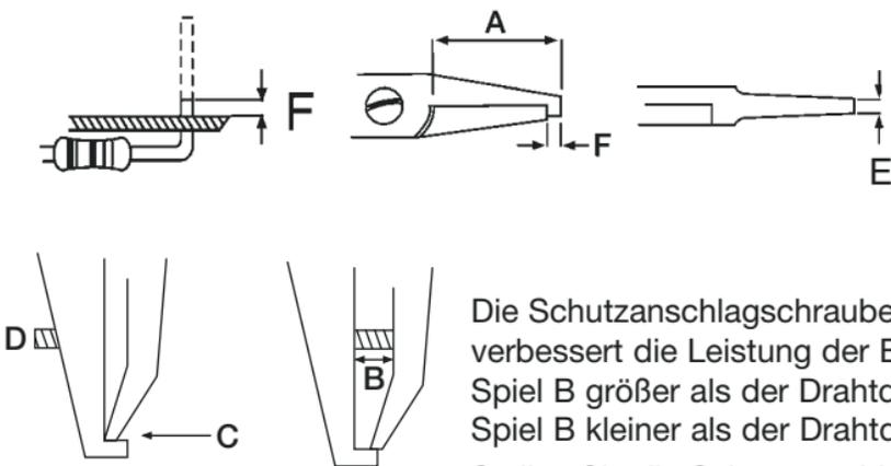
Die Schutzanschlagschraube D verbessert die Leistung der Erem Distanzschneider:
