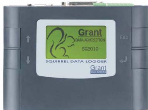
Der Squirrel 2010 ist ein robuster, flexibler Datenlogger mit 4 bis 8 Analogeingängen zur Messung von Strom, Spannung, Widerstand, Temperatur. Außerdem hat das Gerät 8 Digitaleingänge zur Aufzeichnung von Statussignalen sowie zum Triggern von Start oder Stopp des Loggers.
