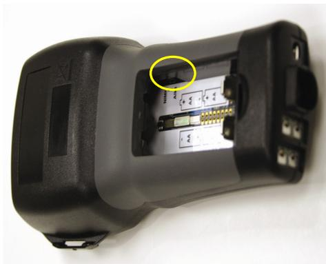
Abbildung B-1: Lage des DIP-Schalters
