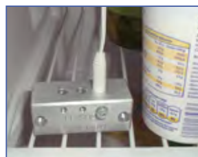
Aluminiumblock verzögert die Ansprechzeit des Fühlers Aluminium block delays the response time of the probe
