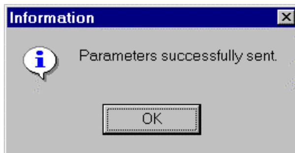
Ein Druck auf die OK-Taste schließt das Fenster und das Instrument beginnt sofort mit der Messung.
