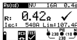
Abb. 5.38: Beispiel eines Ergebnisses der Messung des Fehlerschleifenwiderstands ( $R_s$ )
