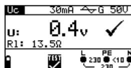
Abb. 5.22: Beispiel für die Ergebnisse einer Berührungsspannungsmessung
