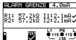
Abb. 5.8: Simulierung des ersten Fehlers zwischen L2 und PE
