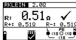
Abb. 5.14: Beispiel eines Ergebnisses der Niederohmmessung
