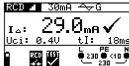
Abb. 5.26: Beispiel für ein Ergebnis der Auslösestrommessung
