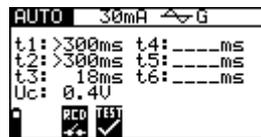
Abb. 5.30: Ergebnisse des Schritts 3 der RCD-Automatikprüfung
