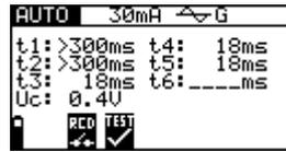
Abb. 5.32: Ergebnisse des Schritts 5 der RCD-Automatikprüfung
