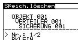
Abb. 6.8: Menü zum Löschen der gespeicherten Messergebnisse
