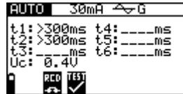
Abb. 5.29: Ergebnisse des Schritts 2 der RCD-Automatikprüfung
