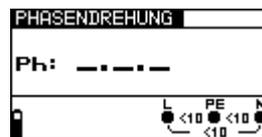
Abb. 5.42: Menü zur Prüfung der Phasendrehung
