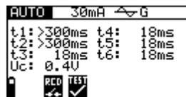
Abb. 5.33: Ergebnisse des Schritts 6 der RCD-Automatikprüfung
