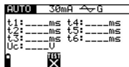
Abb. 5.27: Menü zur automatischen Prüfung der Fehlerstrom-Schutzeinrichtung
