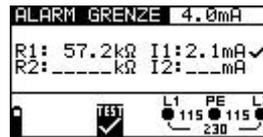
Abb. 5.7: Simulierung des ersten Fehlers zwischen L1 und PE
