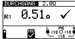
Abb. 5.18: Beispiel eines Ergebnisses der Durchgangsmessung
