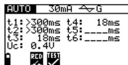
Abb. 5.31: Ergebnisse des Schritts 4 der RCD-Automatikprüfung
