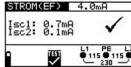
Abb. 5.6: Beispiel eines Ergebnisses der Fehlerströme im Falle des ersten Fehlers
