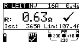
Abb. 5.41: Beispiel eines Ergebnisses der Leitungswiderstandsmessung
