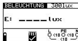
Abb. 5.14: Menü zur Beleuchtungsmessung
