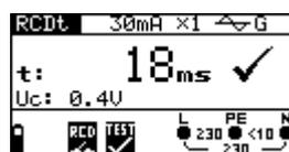
Abb. 5.24: Beispiel für ein Ergebnis der Auslösezeitmessung
