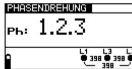
Abb. 5.44: Beispiel des Prüfergebnisses für die Phasenfolge
