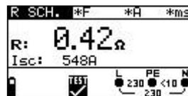
Abb. 5.36: Beispiel eines Ergebnisses der Messung des Fehlerschleifenwiderstands
