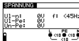
*Abb. 5.45: Menü für Spannungs- und Frequenzmessung*
