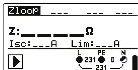
Bild 5.23: Fehlerschleifenimpedanz
