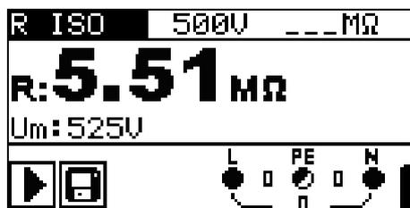
Bild 5.7: Beispiel für ein Ergebnis einer Isolationswiderstandsmessung
