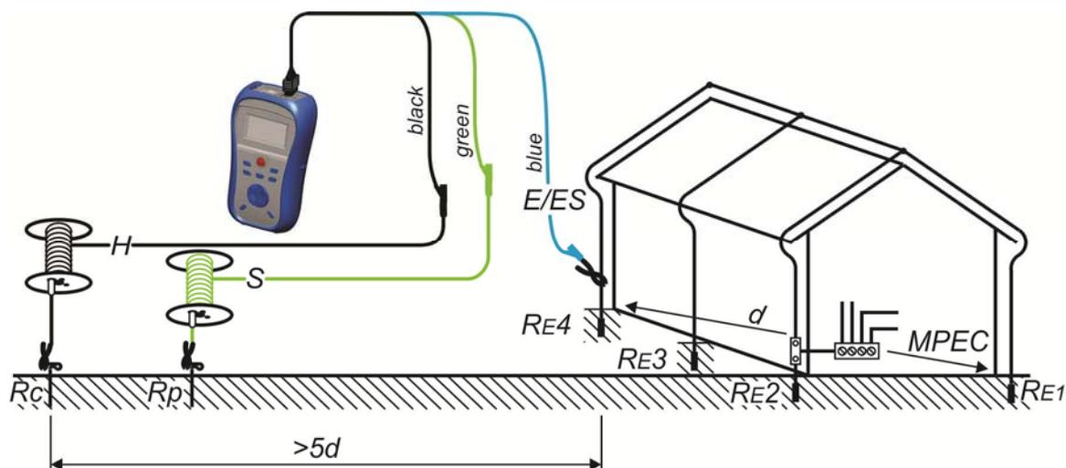
Bild 5.334: Widerstand zu Erde, Messung einer Blitzschutzanlage
