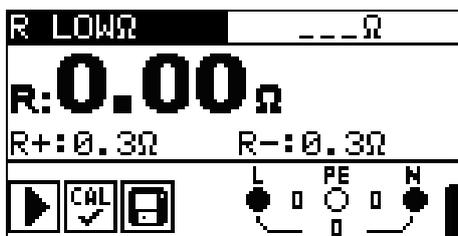
Bild 5.10: Beispiel für ein R LOW $\Omega$ -Ergebnis
