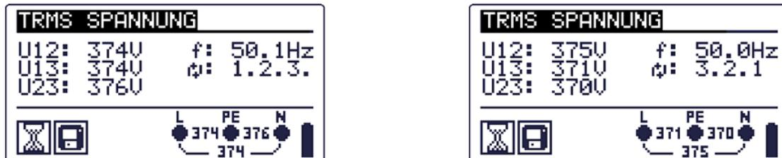
Bild 5.4: Beispiel für eine Spannungsmessung im Drehstromnetz
