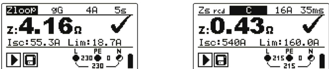
Bild 5.25: Beispiele für Messergebnisse der Schleifenimpedanz
