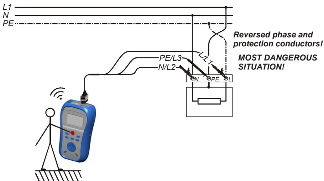
Bild 5.367: Vertauschte Leiter L und PE (Anwendung des Universalprüfkabels)
