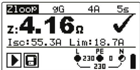
Bild 3.5: Typisches Funktionsdisplay
