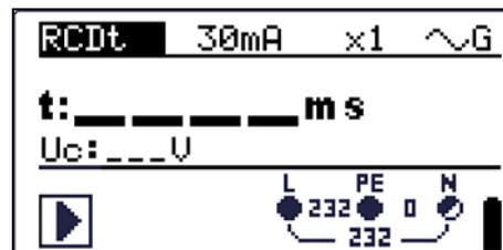
Bild 5.16: RCD-Prüfung
