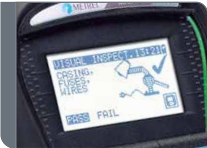
Große LCD-Anzeige mit Hintergrundbeleuchtung und PASS/FAIL-Ausgabe.
