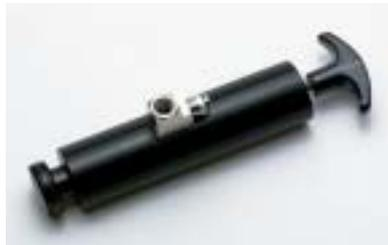
**Beschreibung:** Fluke 700 PMP ist eine Handpumpe zur Erzeugung von Druck bis 10 bar. Ausgangsanschluss 1/8"-NPT Innengewinde.
