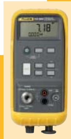
Mit einer Länge von weniger als 23 cm und einem Gewicht von knapp 1 kg ist der robuste 718 ein ideales Messgerät für den mobilen Einsatz. Er wird sowohl in einer 2-bar-Ausführung als auch als 7-bar-Modell angeboten und eignet sich für trockene Luft und nicht-korrosierende Gase. Eine eingebaute Pumpe erzeugt Druck oder Vakuum. Außerdem stehen Min-, Max- und Hold-Funktionen zur Verfügung.
