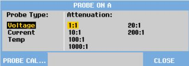
Wenn bereits der richtige Tastkopftyp ausgewählt ist (gelb unterlegt), können Sie mit Schritt 5 fortfahren.
