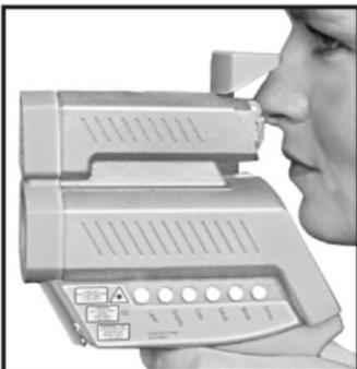
Schwenken Sie die Verschlusskappe am Ende der Kamera nach oben und visieren Sie Ihr Aufnahmeobjekt an, wie unten gezeigt. Das eingeprägte Dreieck zeigt Ihnen die ungefähre Bildbreite an.
