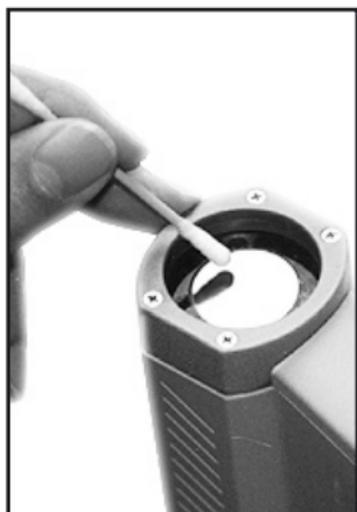
Linsenreinigung: Staub und andere lose Partikel mit Druckluft wegblasen. Verbleibenden Schmutz mit einem weichen Pinsel oder einem Wattestäbchen entfernen. Das Wattestäbchen kann mit Wasser oder einem wasserlöslichen Reinigungsmittel befeuchtet werden. **Niemals** Lösungsmittel zum Reinigen von Linse oder Gehäuse verwenden.
