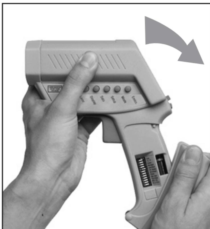
Öffnen Sie das Batteriefach durch leichten Druck auf die oberen Griffhälften.
