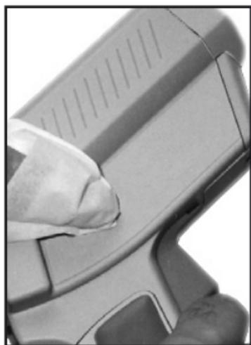
Gehäusereinigung: Je nach Verunreinigung mit trockenem oder feuchtem (nicht tropfnassem) Tuch oder Schwamm abwischen.
