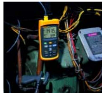
Mit Toolpak, einem optionalen Zubehör, können die Thermometer Fluke 50 Serie II an beliebigen Metallgegenständen (mit dem starken Magneten) aufgehängt oder an einem Rohr (mit den Hook-and-Loop-Gurten) befestigt werden, um das Messgerät freihändig bedienen zu können.
