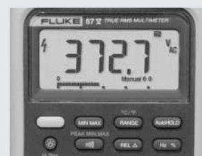
Abbildung 2. Ausgangsspannungsanzeige mit aktiviertem Tiefpassfilter.
