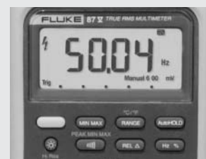
Abbildung 4. Ausgangsfrequenz (Motordrehzahl) mit Tiefpassfilter.
