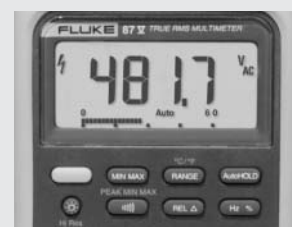
Abbildung 1. Ausgangsspannungsanzeige ohne Tiefpassfilter.
