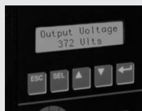
Abbildung 2. Ausgangsspannungsanzeige mit aktiviertem Tiefpassfilter.
