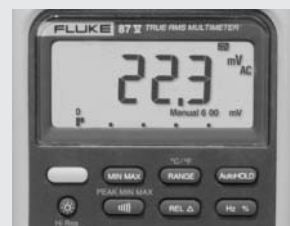
Abbildung 6. Ausgangsstromanzeige mit aktiviertem Tiefpassfilter.
