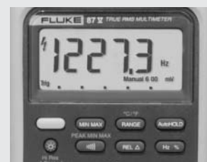
Abbildung 3. Ausgangsfrequenz (Motordrehzahl) ohne Tiefpassfilter.
