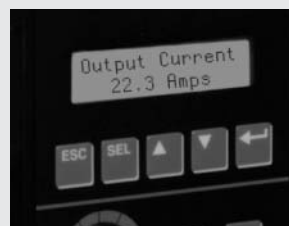
Abbildung 6. Ausgangsstromanzeige mit aktiviertem Tiefpassfilter.
