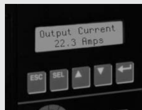
Abbildung 5. Ausgangsstromanzeige ohne Tiefpassfilter.
