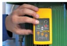
Ermittlung der Drehrichtung von laufenden Motoren durch Platzieren des Messgeräts auf dem Motorgehäuse
