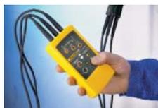
Ermittlung der Drehfeldrichtung in mehrphasigen Stromnetzen
