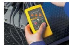
Überprüfung der richtigen Motordrehrichtung vor dem Anschließen
