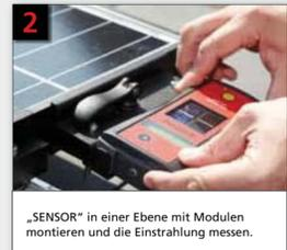
„SENSOR“ in einer Ebene mit Modulen montieren und die Einstrahlung messen.
