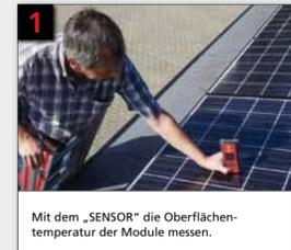
Mit dem „SENSOR“ die Oberflächentemperatur der Module messen.
