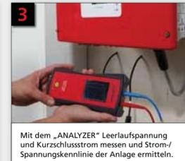
Mit dem „ANALYZER“ Leerlaufspannung und Kurzschlussstrom messen und Strom-/Spannungskennlinie der Anlage ermitteln.
