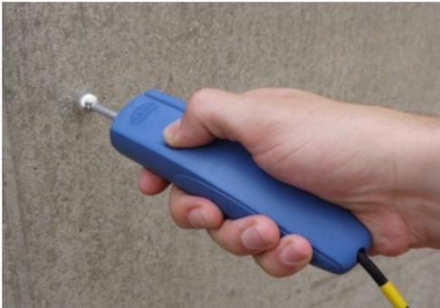
Halten Sie das Gerät bei Messungen stets am unteren Teil des Gehäuses fest.
