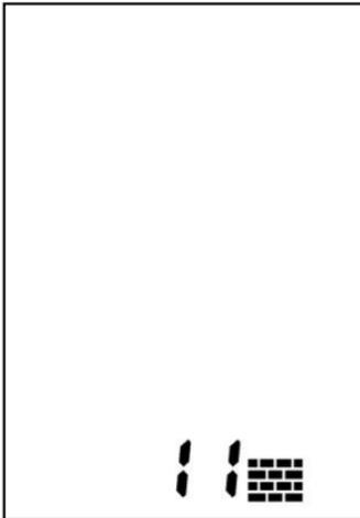
Angezeigt wird die eingestellte Materialkennzahl mit dem Symbol für Materialfeuchte
