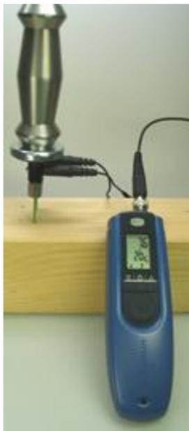
Die beiden Nadeln der Ramm-Elektrode sind mit dem Gleithammer quer zur Faserrichtung bis in die gewünschte Messtiefe einzuschlagen. Um die Kernfeuchte ermitteln zu können, müssen die Elektrodenspitzen bis in 1/3 der gesamten Holzstärke eindringen.
