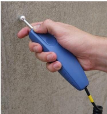
Bei der Messung beeinflusst die Hand das Messfeld der Kugelelektrode und verändert dadurch den Messwert.
