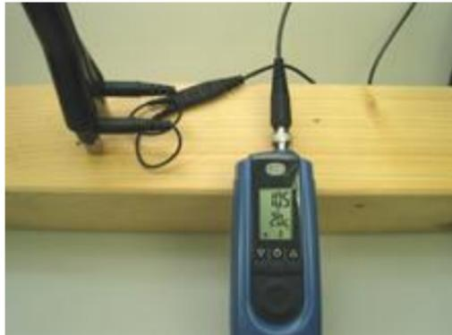
Abbildung 4-3 Messung quer zur Faserrichtung mit M 20
