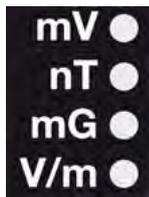
Durch ein regelmäßiges, kurzes Aufblitzen wird die Einheit des durch kurzes Drücken der „Mode >“ Taste wählbaren alternativen Messparameters signalisiert.
