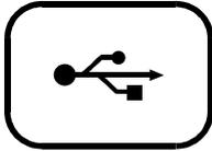
USB 1.0-Buchse zum Anschluss des NFA für die Konfiguration mit der Software NFAsoft. Verbindung bitte nur bei ausgeschaltetem Gerät herstellen oder lösen!
