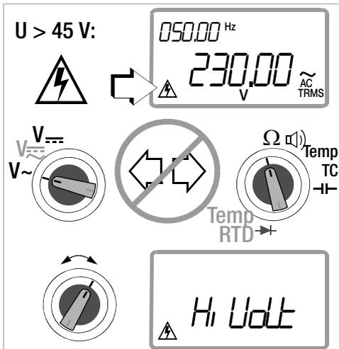
so bleibt das Hochspannungswarnsymbol in der Anzeige sichtbar.
