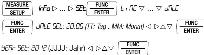
Datum und Uhrzeit müssen nach einem Batteriewechsel erneut eingegeben werden.
