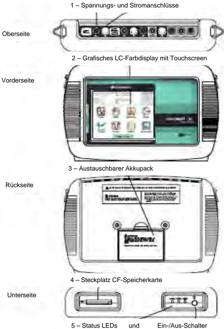
1. **Spannungs- und Stromanschlüsse** – es stehen je vier Kanäle für Spannung und Strom zur Verfügung, welche für die Messung vielfältiger Stromkreisconfigurationen angeschlossen werden können. Für den bestimmungsgemäßen Gebrauch sind ausschließlich Spannungsmesskabel und Stromzangen von Gossen Metrawatt zu verwenden. Angegebene Messbereiche dürfen nicht überschritten werden.
