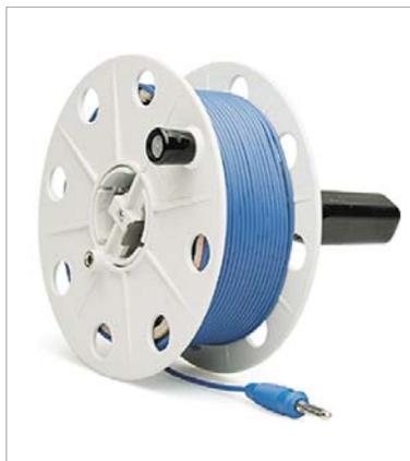
50 m Messleitung, aufgewickelt auf eine Metalltrommel. Der Anschluss an das eine Ende der Messleitung ist über eine in die Trommel integrierte Buchse möglich. Das andere Ende ist mit einem Bananenstecker ausgerüstet. Die Trommelachse mit Griff ist steckbar, sodass die Trommel platzsparend aufbewahrt werden kann. Der Widerstandsanteil des Kabels kann in der Schalterstellung  $R_{LO}$  kompensiert werden.
