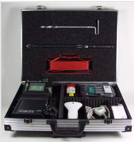
Im Tragkoffer K2000 ist gegenüber der Tragtasche F2000 zusätzlich Platz für drei verschiedene Drehstromadapter, Haspel mit Messleitung, Teleskopstab, Erdbohrer und Sonde 1081.
