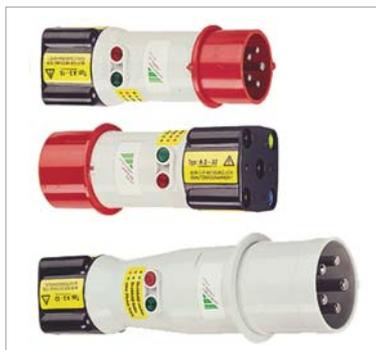
Die Drehstromadapter A3-16, A3-32 und A3-63 dienen dem problemlosen Anschließen von Prüfgeräten an 5-polige CEE-Steckdosen. Die drei Ausführungen unterscheiden sich durch die Größe des Steckers, der jeweils den 5-poligen CEE-Steckdosen mit den Nennströmen 16 A, 32 A, 63 A entspricht. Die Phasenfolge wird jeweils durch Lampen signalisiert.
