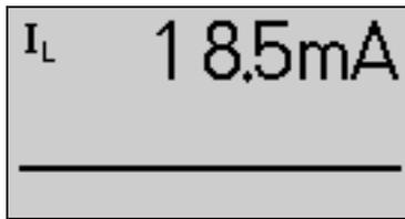
Die Schalterstellung des jeweiligen Zangenstromwandlers muss den Bereichen des jeweils gewählten Messparameters  $I_L$  oder  $I_{AMP}$  angepasst werden!
