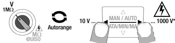
Im Display wird die gewählte Prüfspannung bei der Messung eingeblendet.
