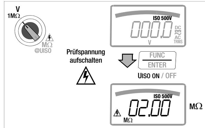
Bei der Isolationswiderstandsmessung ist die Messbereichsautomatik aktiv.
