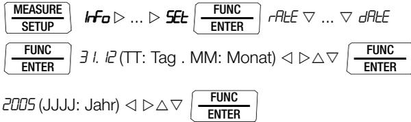
Datum und Uhrzeit müssen nach einem Batteriewechsel erneut eingegeben werden.
