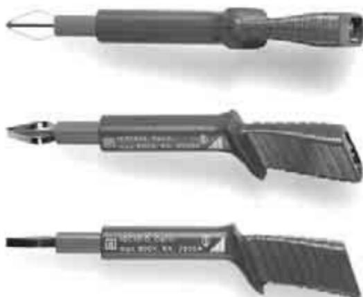
Drei selbsthaltende Prüfspitzen mit Berührungsschutz zum Anschluss von Messleitungen mit 4 mm-Bananensteckern bzw. mit berührungsgeschützten Steckern an Buchsen mit Öffnungen von 3,5 mm bis 12 mm, z.B. CEE-, Perilex-Steckdosen
