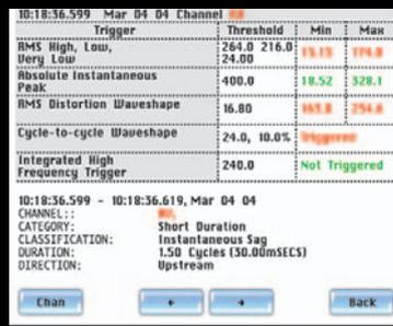
Für noch schnellere Analysen verfügt der MAVOWATT 40 über zusätzliche AnswerModules® sowie intelligente Algorithmen die helfen, Quelle und Ursache von Netzqualitätsproblemen genau auszumachen. Diese Diagnose- und Auswertewerkzeuge basieren auf jahrzehntelanger Erfahrung in Analyse, Bewertung und Fehlersuche. Sie verwandeln Rohdaten in präzise Antworten für eine schnelle Entscheidungsfindung.
