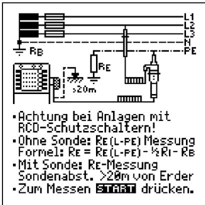
Angeschlossen werden: 2-Pol-Adapter und Sonde
