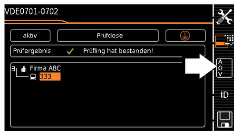
Die Anzeige des Speicherbildschirms ist abhängig von der Einstellung im Setup-Menü der Schalterstellung **SETUP**: Setup 1/3 > Autom. Messungen > Am Sequenzende > **Speicherbildschirm**.
