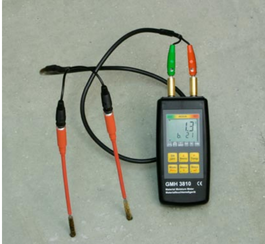
Betonmessung mit Bürstensonnen GBSL91
