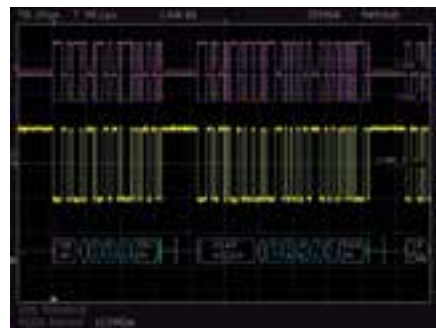
HEX dekodiertes CAN Bussignal
