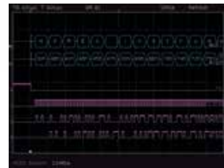
SPI Bussignal, MISO / MOSI dekodiert
